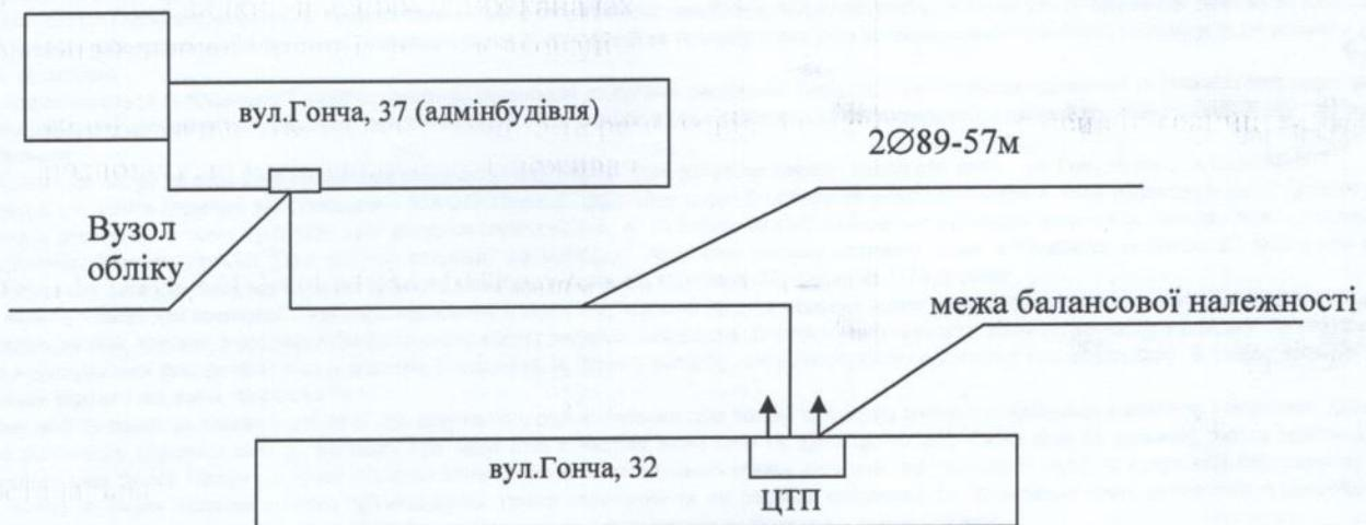
**Технічна характеристика теплотраси**
