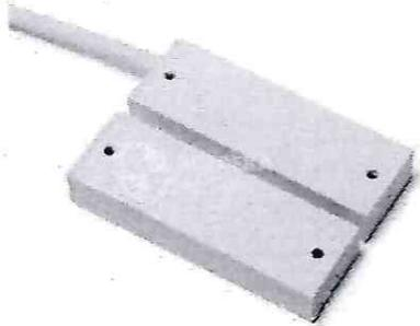
Датчик відкриття магнітогерконовий (геркон) на металеві поверхні, накладний тип встановлення, корпус пластиковий, черговий режим - 15мм, режим тривоги - 28мм. Колір: білий.
